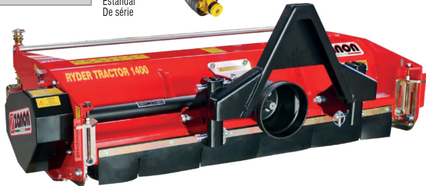
Attacco a 3 punti cat. 0 (attacco rapido a triangolo) 3-point linkage cat. 0 (quick triangle connection) Dreipunktanbaueck Kat. 0 (Kuppeldreieck) Enganche de 3 puntos cat. 0 (conexión rápida) Attelage à 3 points cat. 0 (triangle à connexion rapide)
