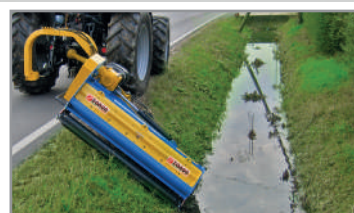
Posizione laterale inclinata Inclined side position Geneigte Position Posición lateral inclinada Position latérale inclinée
