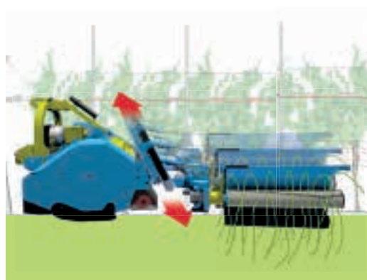
Regolazione altezza asse rullo Arm's height adjustment Einstellung Arbeitsposition Regulación de altura del rodillo Réglage hauteur axe du rouleau
