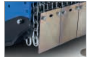
Doppia fila catene antiurto Double Internal chain shock absorbing Doble Innekettenvorhang Doble Cadena de protección delantera Double Chaîne antichocs
