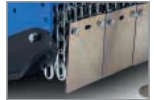
Doppia fila catene antiurto Double Internal chain shock absorbing Doppel Innkettenvorhang Doble Cadena de protección delantera Double Chaîne antichocs
