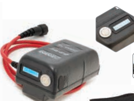
Bouton marche/arrêt - Afficheur graphique multifonction On/off button - Multifunction graphic display Ein-/Aus-Taste - Multifunktions-Grafikdisplay
